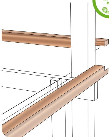
Se coloca an nivel y se termina de reforzar la unión con behuco o clavos para mejorar su resistencia
